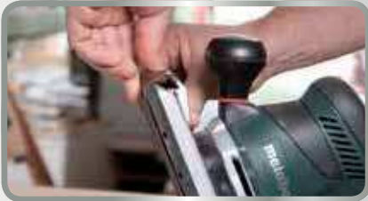
Łatwe mocowanie materiału ściernego Uniwersalny system mocowania umożliwia stosowanie papierów ściernych bez rzepu lub na rzep, a także materiałów ściernych o grubości do 10 mm.
