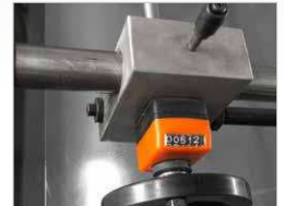
Manualny ogranicznik tylny 600 mm regulowany z milimetrową dokładnością
