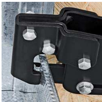
Ustawienie narzędzia do wykonania połączenia
