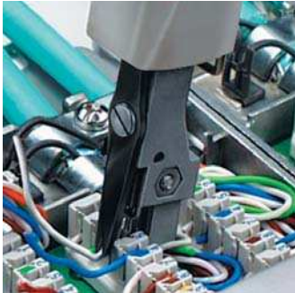
Wciskanie i odcinanie przewodu w jednej operacji
