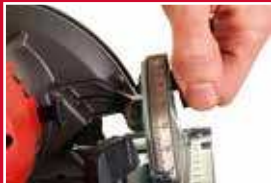
Regulacja kąta przy cięciu skośnym do 50 stopni
