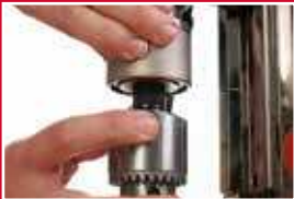
Beznarzędziowy uchwyt Weldon 19 mm
