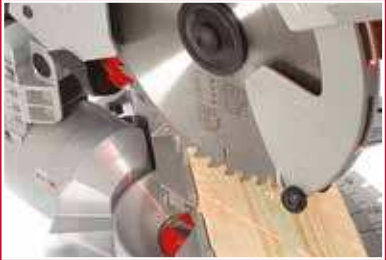
Widoczność linii cięcia
