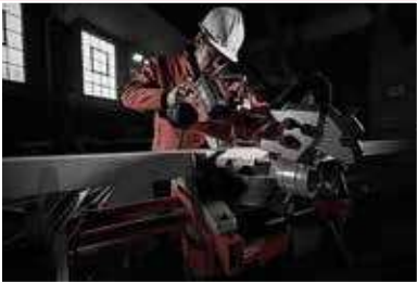
Pierwsza ukośnica 18V - 216 mm z wbudowaną prowadnicą
