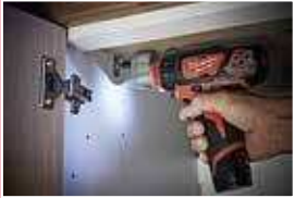
Nasadka z odsadzeniem do pracy w pobliżu krawędzi
