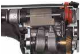
Mechanizm przeciwwagi zapewnia małe drgania - 12.5 m/s²
